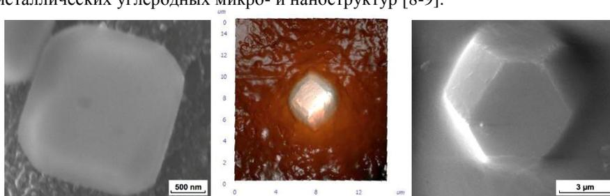
Рис. 1. РЭМ и АСМ-изображения полученных монокристаллов углерода.
