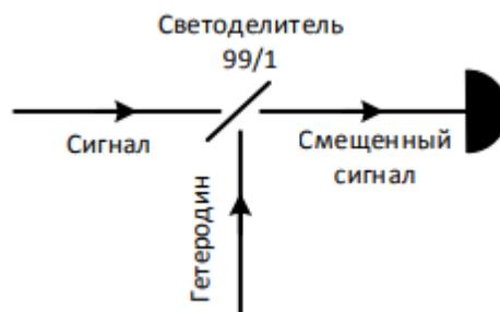
Рис. 1. Теоретическая схема приемника Кеннеди.
