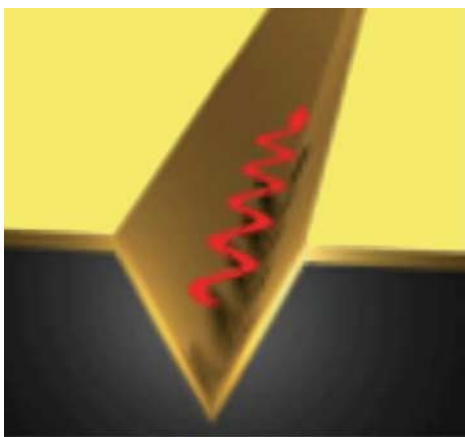
Рис. 5. Бороздка в металле для каналирования плазмонной волны.
